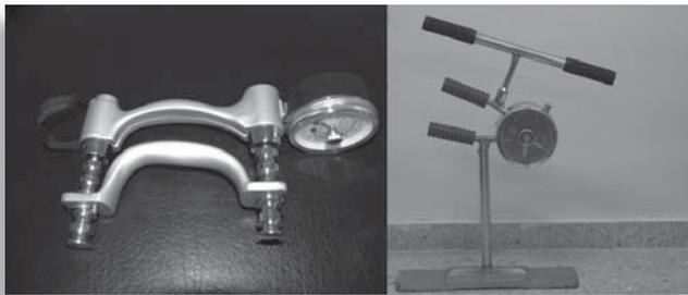
**Figura 17.5.** Dinamómetros. Izquierda: dinamómetro manual; derecha: dinamómetro lumbar.
